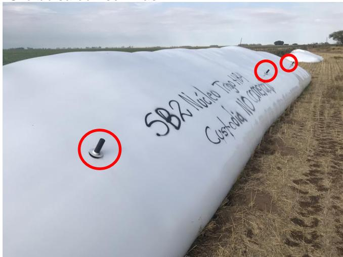
○ Lanza con sensores de movimiento, temperatura, humedad y cantidad de CO<sub>2</sub>
